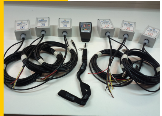
Equipo de varios receptores controlados por un transmisor. Ejemplo: Sistema de riego, cubiertas, toldos, ...
