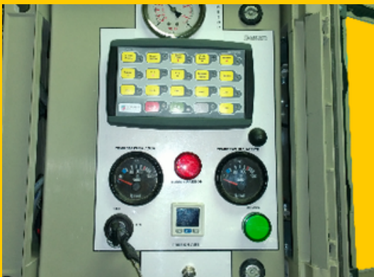
Equipo de control neumático, hidráulico, eléctrico para control de presiones. Ejemplo: Cubas de limpieza, ...
