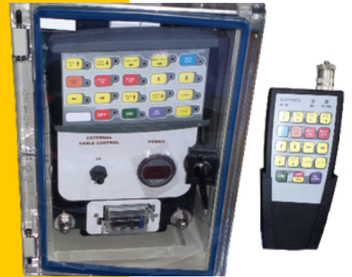
Equipo para control neumático, hidráulico, eléctrico con inclinómetro Ejemplo: Camiones, grúas con plataforma siempre a nivel.
